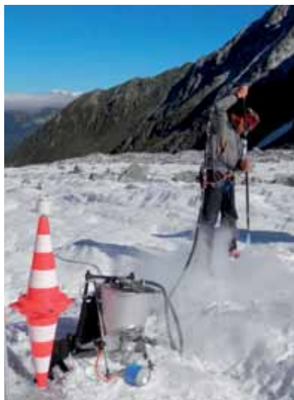
Figure 7. Différentes étapes du déploiement d'un réseau de Geocubes. Haut gauche : monumentation d'un récepteur mobile sur glace. Haut droit : monumentation d'un récepteur fixe. Bas : installation du coordinateur et d'une connexion internet par satellite.
