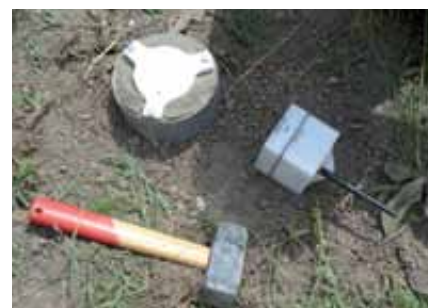
Figure 7. Différentes étapes du déploiement d'un réseau de Geocubes. Haut gauche : monumentation d'un récepteur mobile sur glace. Haut droit : monumentation d'un récepteur fixe. Bas : installation du coordinateur et d'une connexion internet par satellite.
