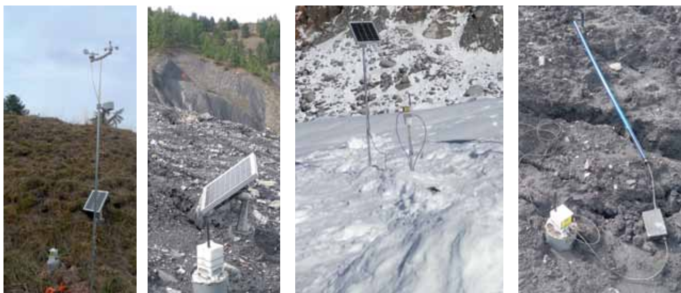
Figure 3. Couches capteurs. De gauche à droite : station météo, pression température et humidité de l'air, sismomètre (sous la neige), sonde d'humidité du sol
