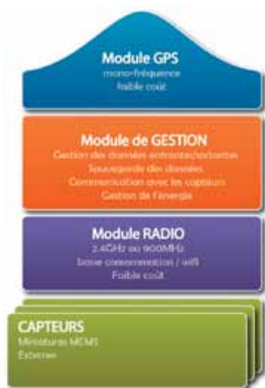
Figure 2. Architecture en modules : schéma fonctionnel (gauche) et intérieur d'un Geocube (droite)
