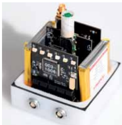
Figure 2. Architecture en modules : schéma fonctionnel (gauche) et intérieur d'un Geocube (droite)
