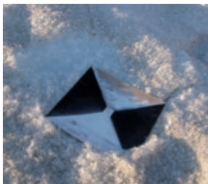
Figure 6. Cible en bois peinte avec cible réfléchissante au centre
