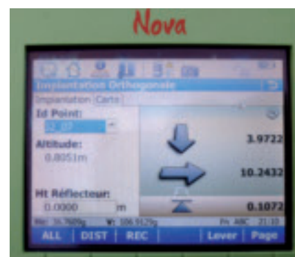
Figure 8. Ecart en temps réel sur la MS50
