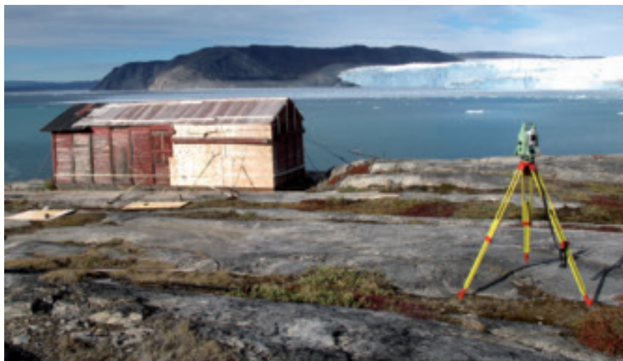
Figure 11. Multistation lors de l'acquisition au scanner laser de la cabane PEV
