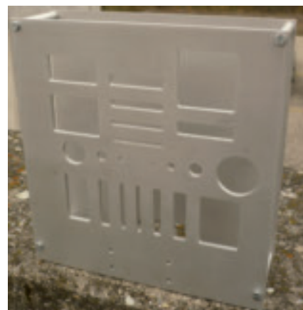
Figure 9. Boîte à trous avec deux faces de même réflectivité
