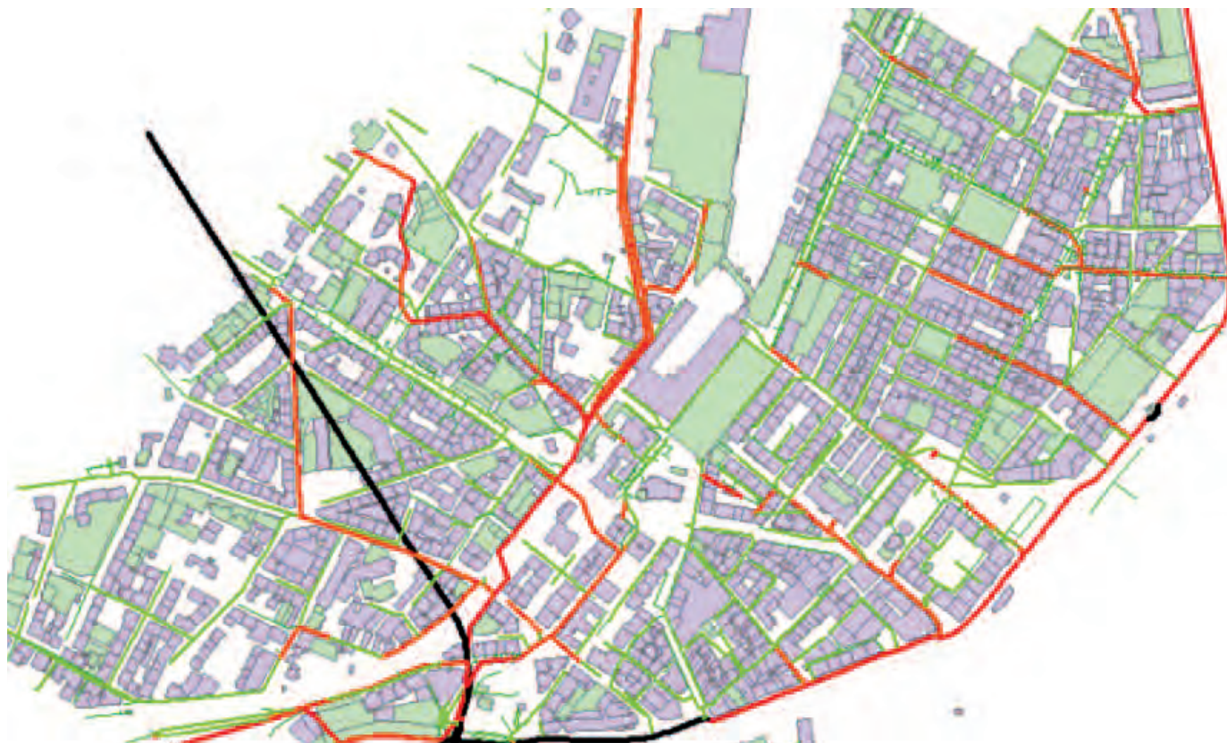
Figure 4. Cartographie du réseau d'assainissement de Genève en fonction de la valeur du diamètre des canalisations
