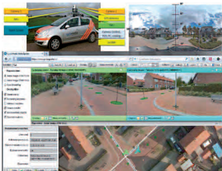
Illustration du principe de fonctionnement d'acquisition photogrammétrique en mobilité
