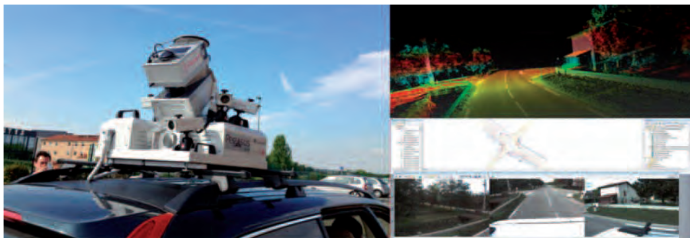
Illustration du principe de fonctionnement d'acquisition LIDAR en mobilité
