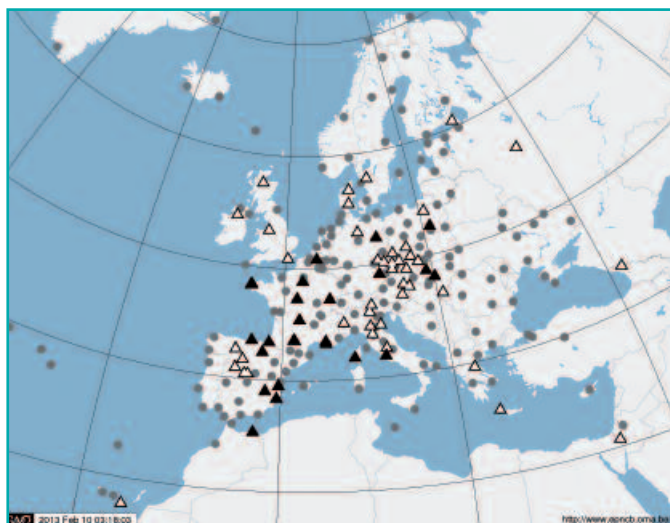
Figure 2. Stations de l'EPN capables d'observer Galileo : ▲ envoient effectivement les données Galileo à EUREF, △ n'envoient pas (encore) les données Galileo à EUREF.
