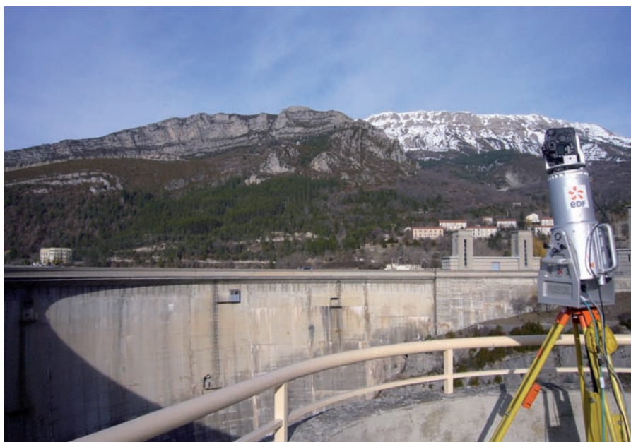
Figure 2. Le laser terrestre statique (Riegl LMS Z420i) en station, positionné en rive droite du parement aval du barrage de Castillon.
