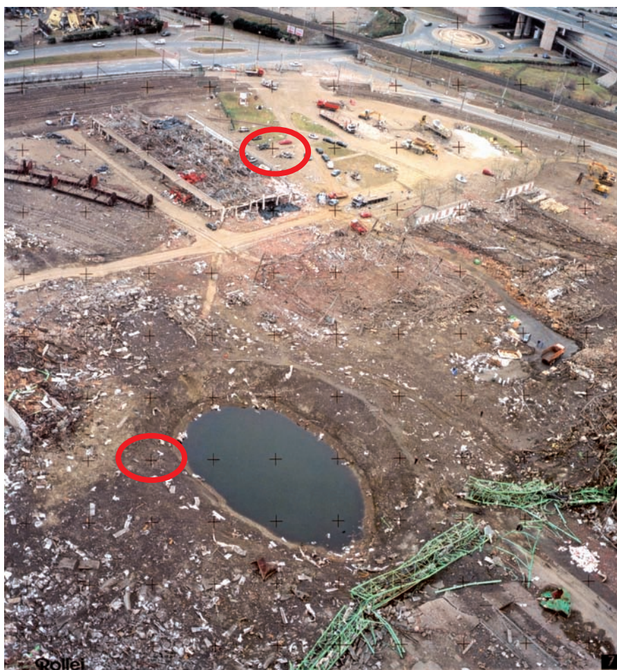
Figure 1. Une des images Rollei-Metric, disposant d'un auto-étalonnage très précis. Deux des croisillons sont entourés en rouge.
