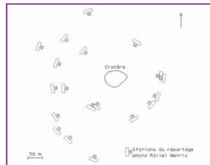
Figure 5. Schéma présentant les positions successives de la caméra lors du lever Rollei-Metric.
