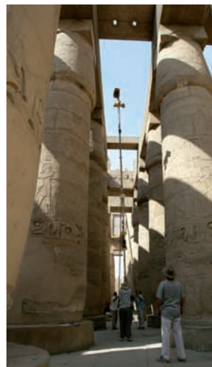
Le mât de prise de vue accueille 4 appareils photos numériques pilotés au sol par un ordinateur portable.
