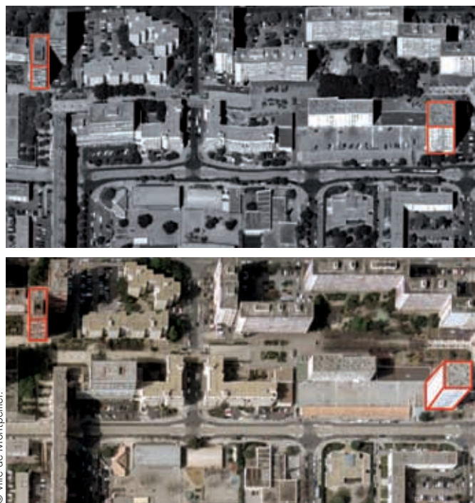
Figure 17. Dévers unidirectionnel en bord d'image acquise par balayage (en haut) et effet de perspective centrale sur extrait de photo (en bas) du même lieu (quartier Mosson).
