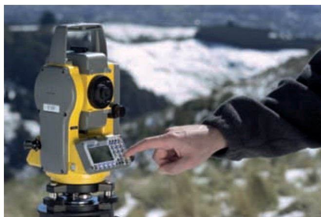
Exemple de station totale à visée sans prisme équipant les services du cadastre aujourd'hui (Trimble M3).
