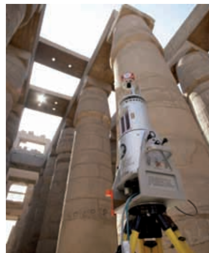
Le scanner Riegl LMS Z 390 dans la salle hypostyle.
