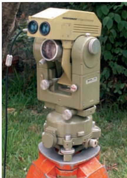
DI 1000 posé sur un T2, mais utilisé aussi avec le T1000.
