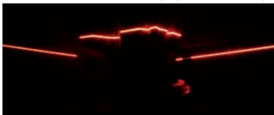
Figure 3. Intersection entre le plan laser et le fragment calcaire dans le noir.
