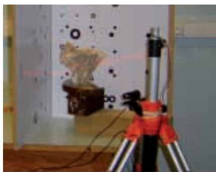
Figure 1. Dispositif expérimental, référentiel d'étalonnage, fragment lapidaire calcaire, ligne rouge laser, webcam et trépied.
