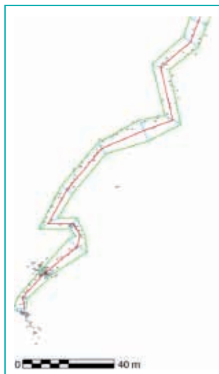
Figure 8. Exemple de trajectoire U-GPS (points reçus en gris) comparée à une polygone spéléo en rouge, avec les largeurs moyennes de la cavité mesurées en vert. A noter, le point central correspond à la balise réceptrice présente en surface. (Résultats d'une campagne de mesures effectuées en mars 2010, en Crète dans la cavité d'Ano Peristeras, à la demande de la municipalité de Karidi, dont le but premier était la recherche d'eau potable, une des nombreuses applications du projet).
