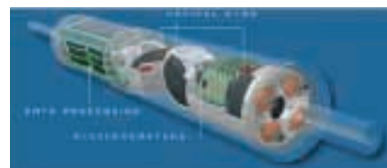
Figure 12. Principe d'un système gyroscopique avec accéléromètres utilisé par l'entreprise de forages dirigés Fordibel.
