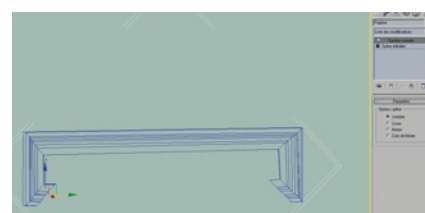
Figure 15. L'outil "section croisée" relie les profils par l'intermédiaire d'un maillage.
