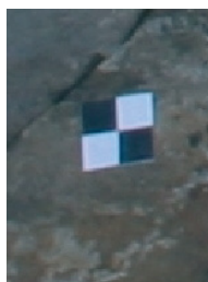
Figure 4. Cible noire et blanche autocollante.
