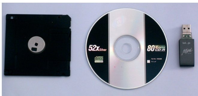
Côte à côte, une disquette 3 1/2 pouces, un CD, une clé USB
