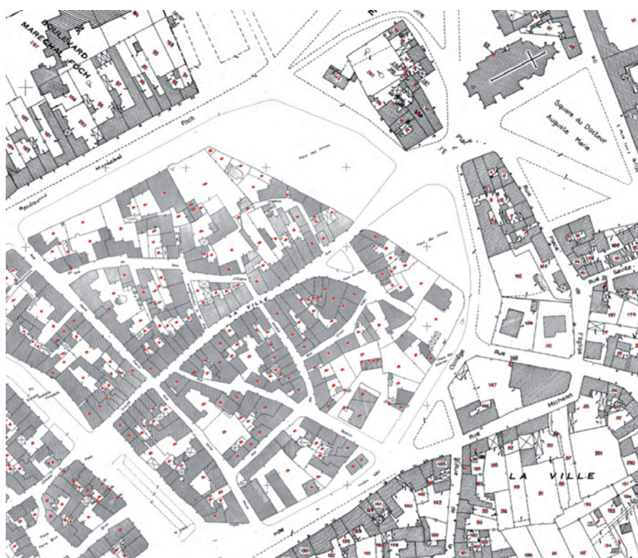
Image sur la commune de Dun-sur-Auron (Cher), illustrant le continuum obtenu par assemblage de plans cadastraux à plusieurs échelles, et faisant apparaître les localisants parcellaires (objets ponctuels porteurs des données attributaires).
