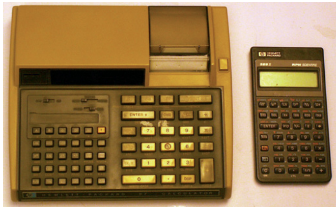
Deux calculatrices de la génération 1975. Une calculatrice de bureau la HP 97, plus lourde et qui peut imprimer les résultats. La calculatrice de terrain HP 32 S II, beaucoup plus légère !
