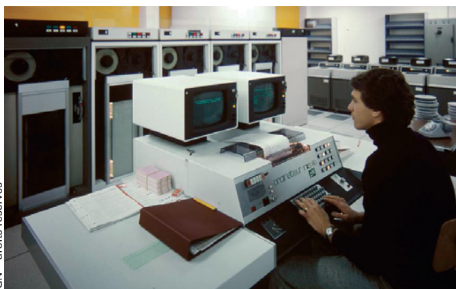
Un ordinateur IRIS 80, à la fin des années 1970. Les résultats sont stockés sur bandes magnétiques, mais les cartes perforées, à gauche de l'opérateur, sont toujours employées pour le traitement des données. Les écrans ne permettent que de visualiser les instructions et résultats chiffrés. Pas de souris, les commandes se font au clavier.
