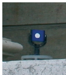
Figure 5. Cible bleue et blanche "tilt and turn".
