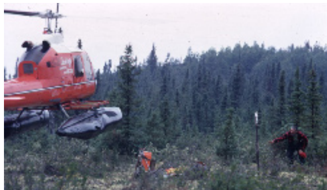
En fin de journée, récupération d'un topographe qui aide à la manœuvre d'atterrissage en terrain encombré par la végétation. Le morceau d'étoffe blanche a permis au pilote d'évaluer la force et la direction du vent.
