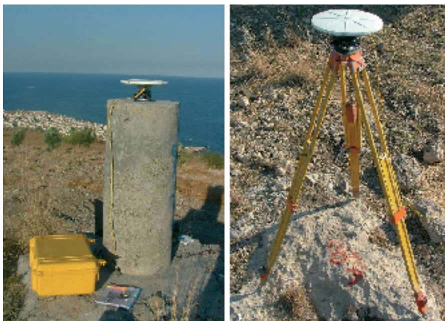
Figure 3 : a. Dispositif d'observation avec pilier en béton à la station ULCN. Le montage de l'antenne se fait par centrage forcé sur la vis positionnée sur la plate-forme.
