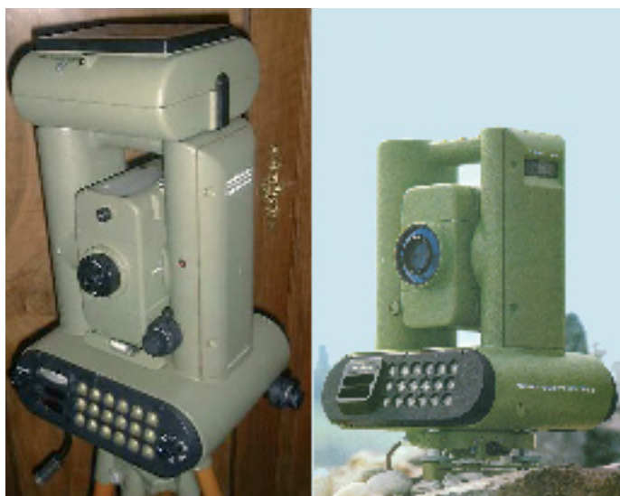
Wild TC1, théodolite électronique de la nouvelle génération avec deux versions : une avec enregistrement des mesures sur coffret extérieur et l'autre avec notation manuelle.
