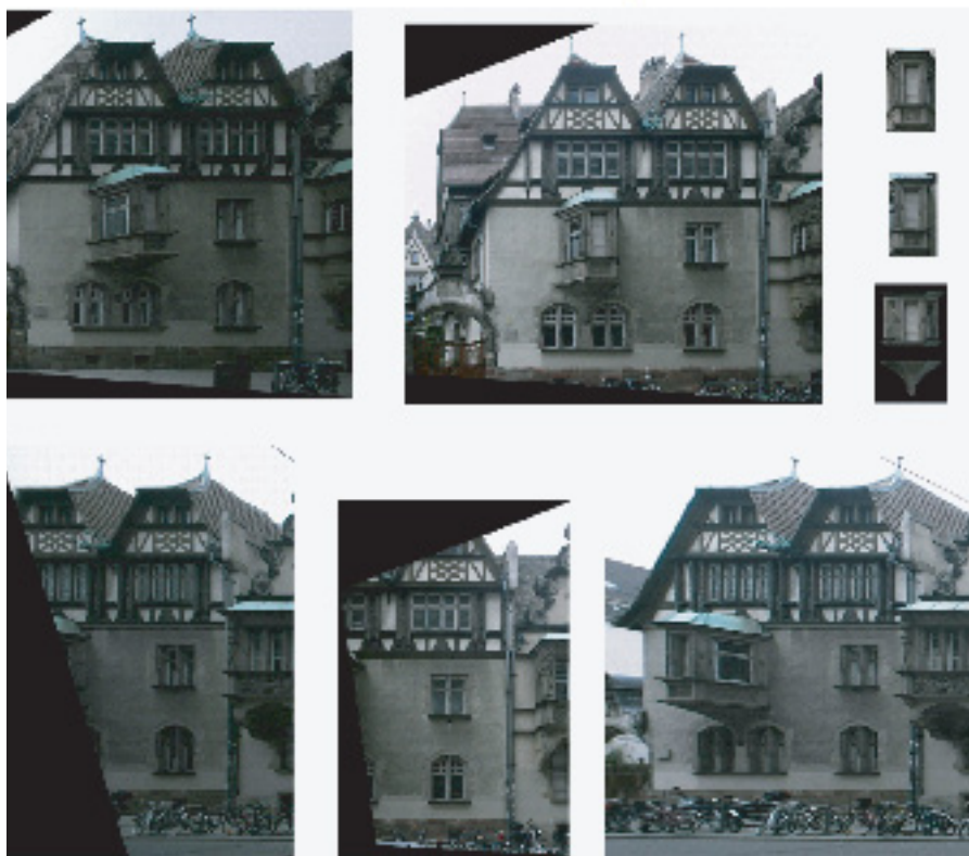
Figure 4. Orthophoto basée sur les images redressées
