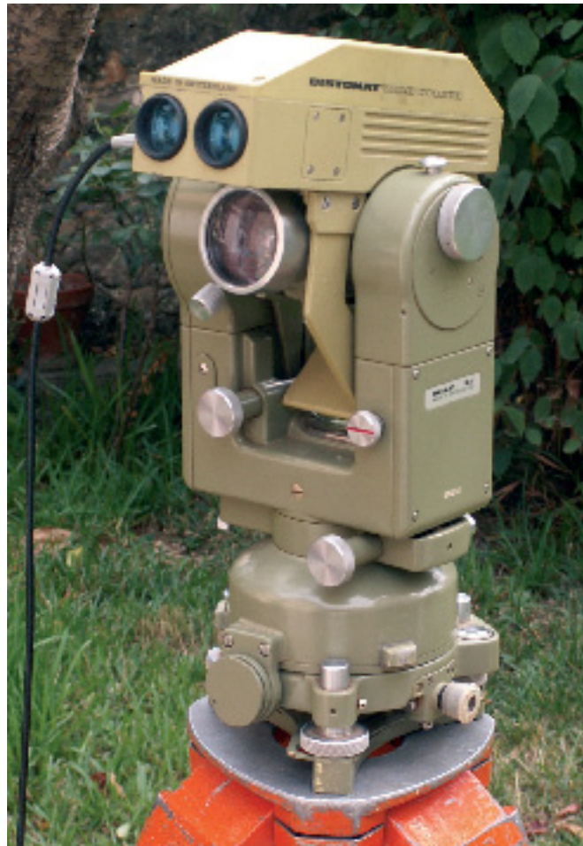
Le DI 1000 distancemètre beaucoup plus compact des générations suivantes. Il n'y a plus de coffret électronique, la miniaturisation électronique et informatique a tout réduit dans un volume restreint. Un câble permettait d'enregistrer la mesure.
