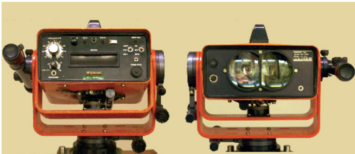
le Geodimeter 14A, produit dans les années 1970 non adaptable à un théodolite. Le volume reste important et il y a toujours deux optiques non coaxiales pour l'émission et la réception du rayon IR. Les distances sont affichées sur LED.
