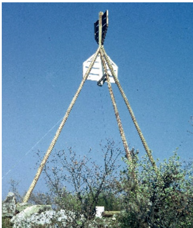
Signal léger de la géodésie de 4° ordre au dessus de sa borne.
