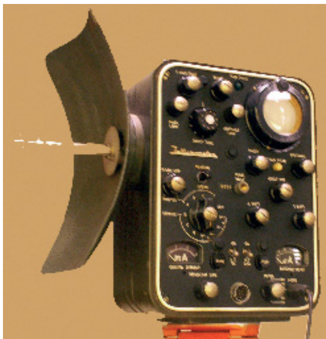
Les Telluromètres MRA1 et 2. Sur le MRA2 on voit l'antenne nécessaire à la propagation des ondes radio. Sur les deux, on voit le petit écran cathodique où se forme le cercle coupé qui permet de déterminer la distance.
