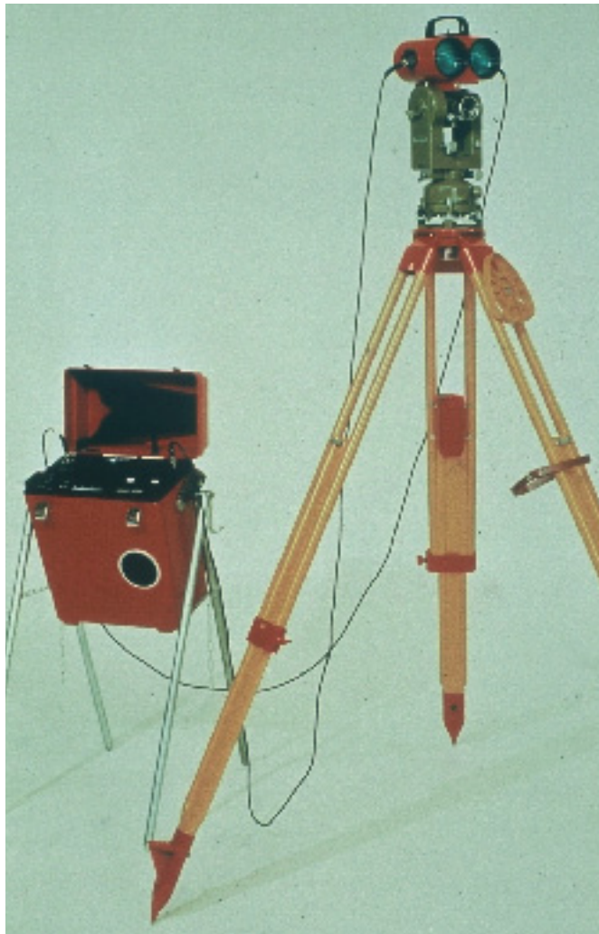
Le DI 10 monté sur un T2. C'est la première association "distancemètre-théodolite".
