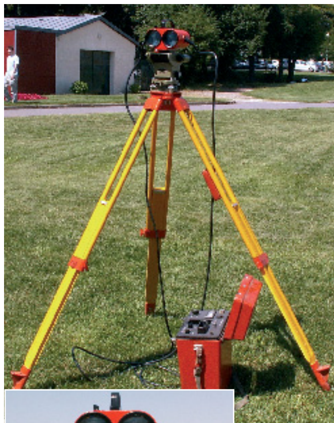
Le distancemètre DI 10. Utilisable seul ou sur la lunette d'un T2 (voir infra dans le paragraphe L'association au théodolite). Avec ses deux optiques
