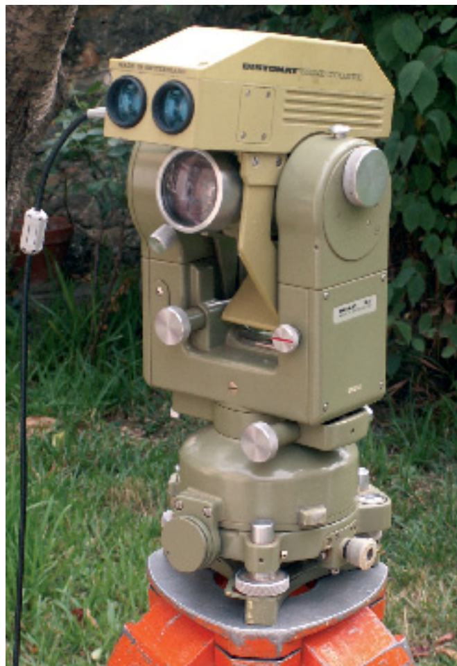
Le DI 1000 distancemètre beaucoup plus compact des générations suivantes. Il n'y a plus de coffret électronique, la miniaturisation électronique et informatique a tout réduit dans un volume restreint. Un câble permettait d'enregistrer la mesure.
