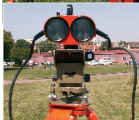
Le distancemètre DI 10. Utilisable seul ou sur la lunette d'un T2 (voir infra dans le paragraphe L'association au théodolite). Avec ses deux optiques
