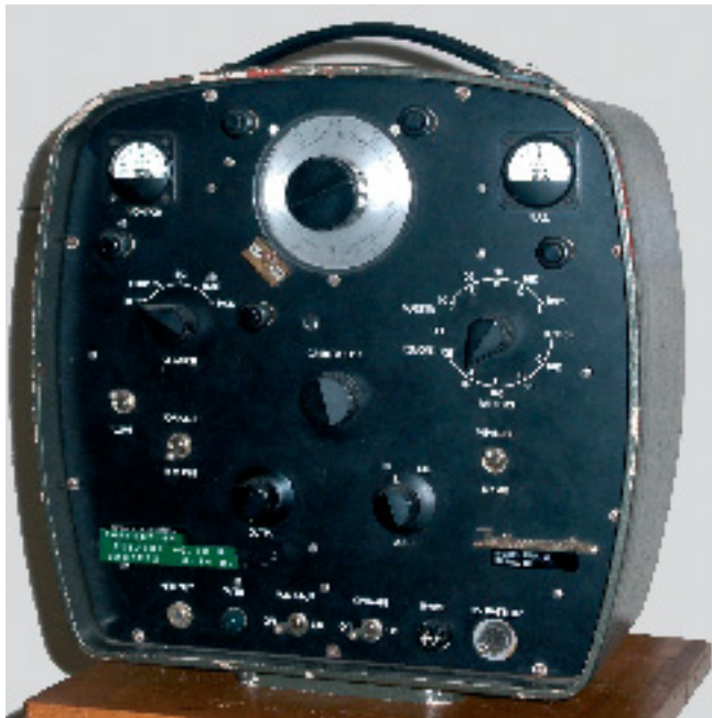
Le Telluromètre MRA 101. L'écran cathodique des MRA 1 et 2 a été remplacé par un cercle gradué.
