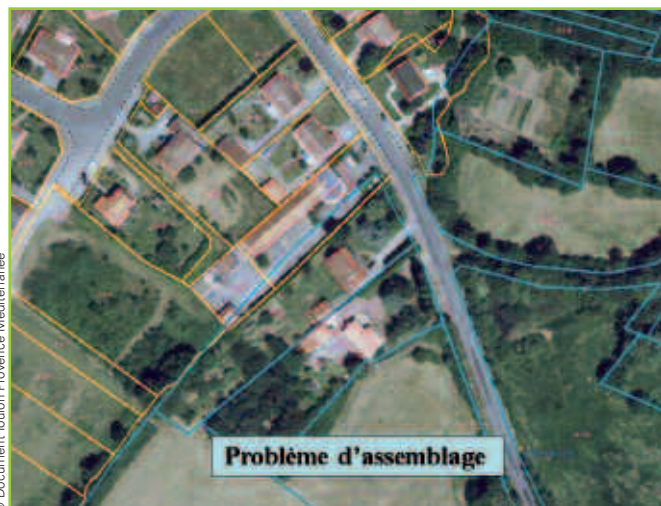
Figure 8. Discordance entre une feuille du cadastre (en jaune) et une autre (en bleu), le calage des constructions n'est pas parfait, une voie n'a pas été régularisée.
