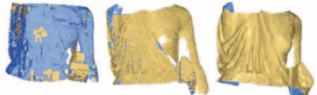
Figure 3 : de gauche à droite, maillage brut du nuage de points brut, maillage brut du nuage de points filtré, modèle final (pour le buste Faro).
