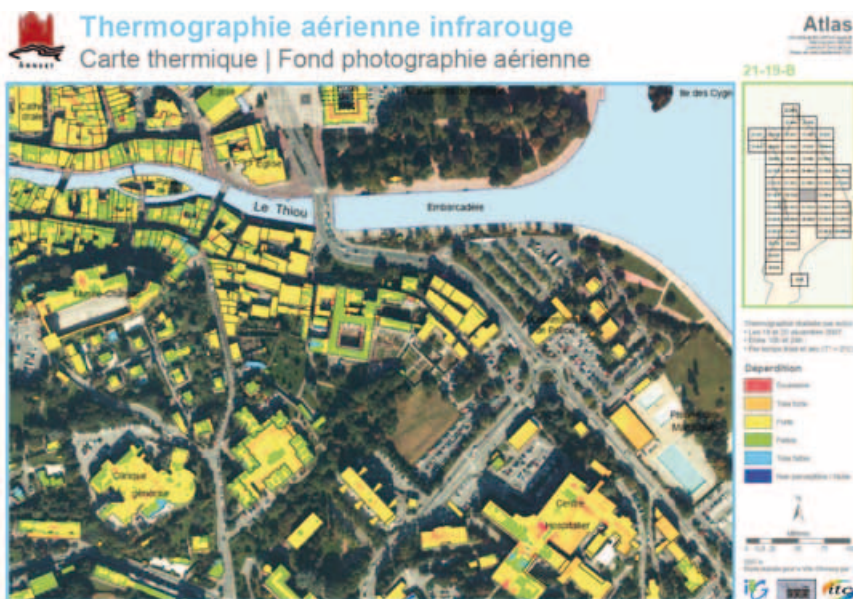
Figure 11. Carte thermique des déperditions détaillées des bâtiments sur Annecy.
