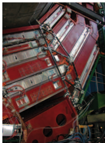
Figure 17. Calibration optique d'un MAB et installation dans une roue YB.
