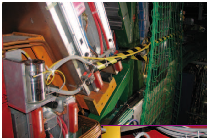
Figure 20. Capteur HLS YB0, liaison vers le réseau principal – capteur HLS dans un pied du YB0 et liaisons vers les 2 autres capteurs des pieds.
