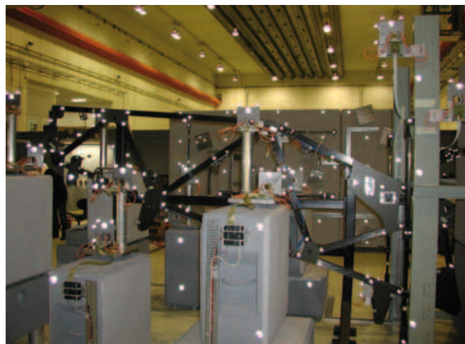
Figure 17. Calibration optique d'un MAB et installation dans une roue YB.
