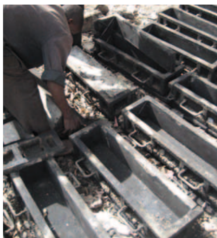
Fabrication de bornes à Gitega au Burundi.
