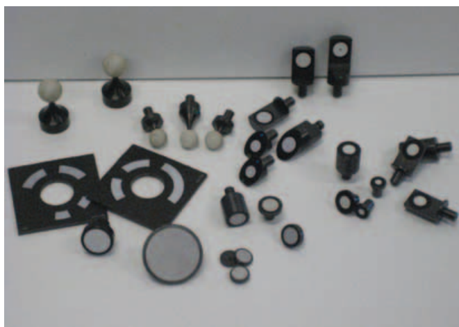
Figure 7. Divers types de cibles photogrammétriques (Aicon et G.M.S) et barre en croix.
