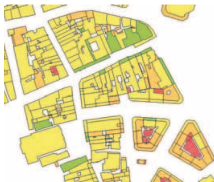
Figure 8. Déperditions thermiques globales des bâtiments sur Annecy (nomenclature identique à la figure 7).
