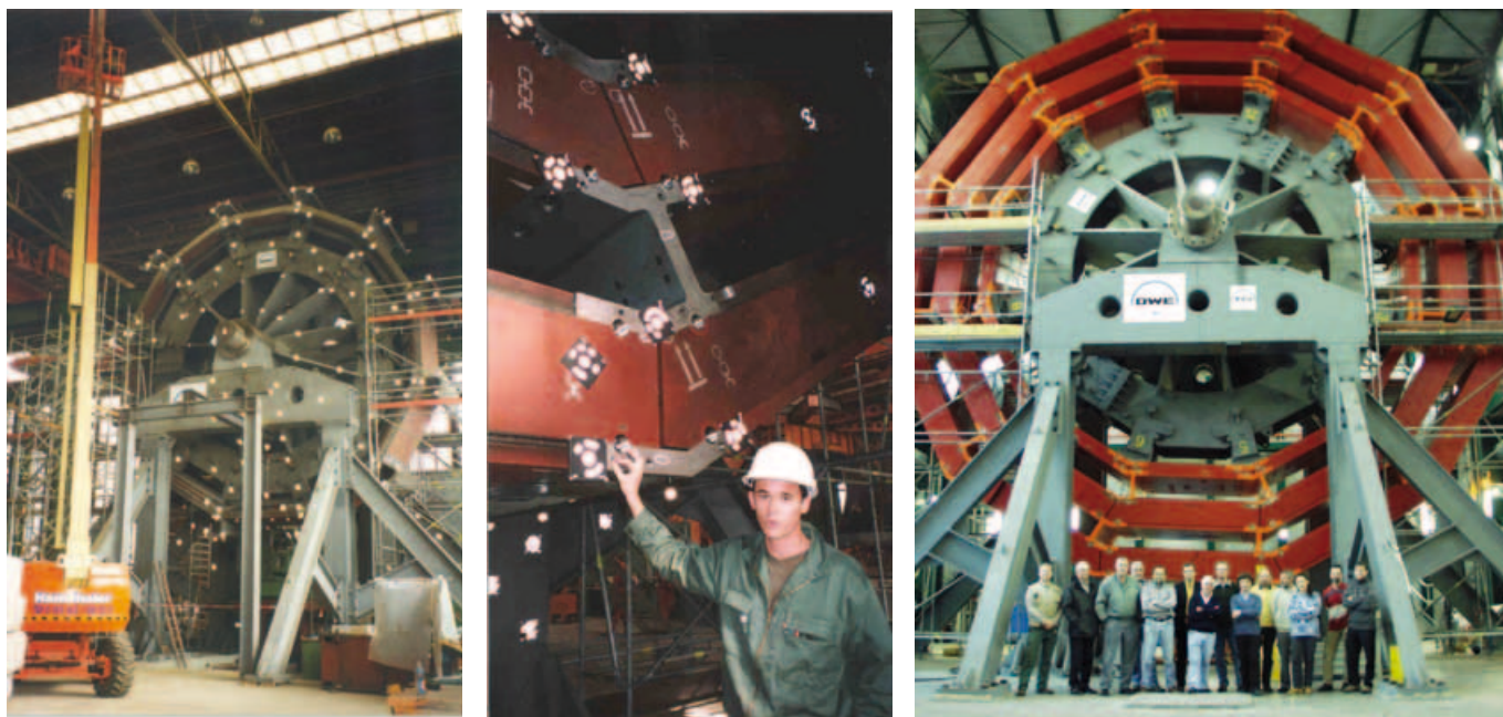
Figure 9. Contrôle en usine (Allemagne) cibles codées magnétiques et sphères rétro-réfléchissantes (production G.M.S) et premier remontage au CERN (2000).
