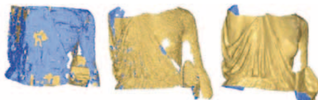
Figure 3 : de gauche à droite, maillage brut du nuage de points brut, maillage brut du nuage de points filtré, modèle final (pour le buste Faro).
