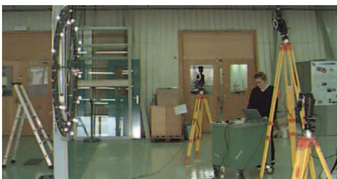
Figure 24. Synchronisation de 3 caméras DCS 620 (interface électronique G.M.S).
