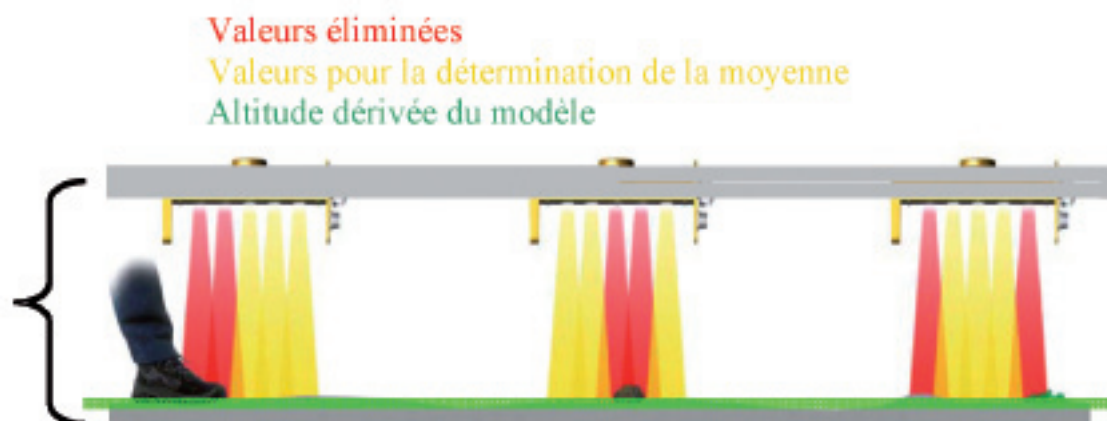
Figure 5. Report altimétrique à partir de mesures de distance qui proviennent de plusieurs capteurs ultrason, à l'exemple de Moba Big Sonic Ski ( www.moba.de ).
