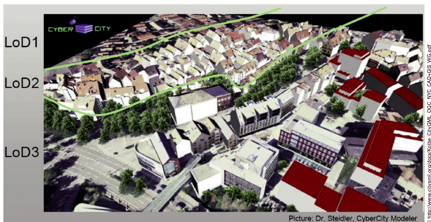
Figure 7. Intégration de différents niveaux de détails selon la distance.
