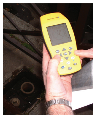
Figure 7 : Géo-localisation d'une bouche d'incendie par relevé GPS
