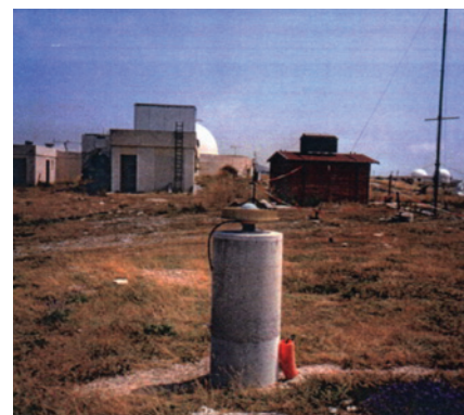
Figure 7 : Le récepteur GPS permanent de l'Observatoire de la Côte d'Azur, sur le plateau de Calern (France).
