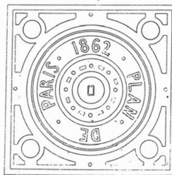
Plan du Chassis et Tampon Echelle de 0,15 pour 1 mètre
