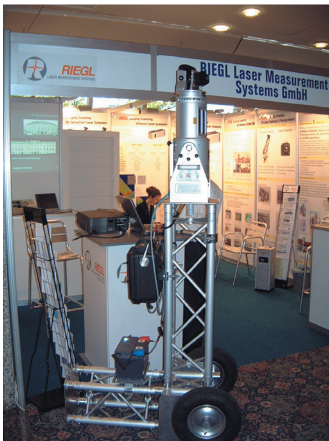
Fig. 4. Le scanner Riegl LMS- Z420i sur un support original
