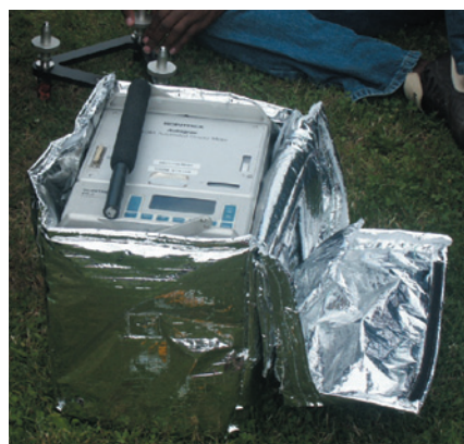
Le gravimètre de l'IPGP, enveloppé dans sa housse isotherme
