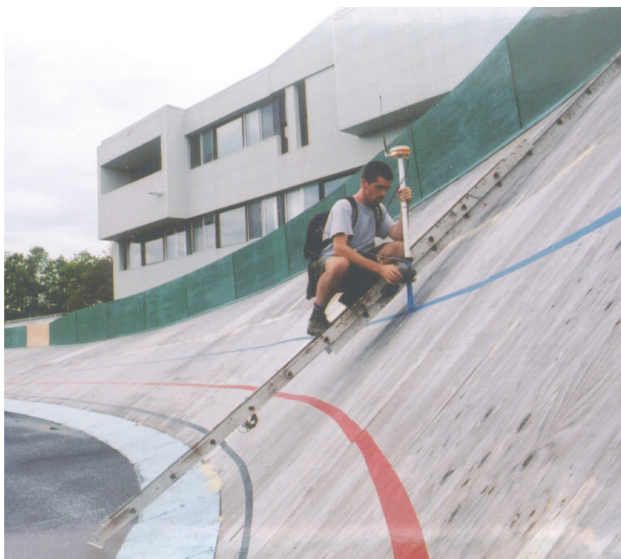
Figure 1 : Relevé GPS-RTK du Vélodrome Louis-Garneau pour la construction d'un modèle numérique de terrain.
