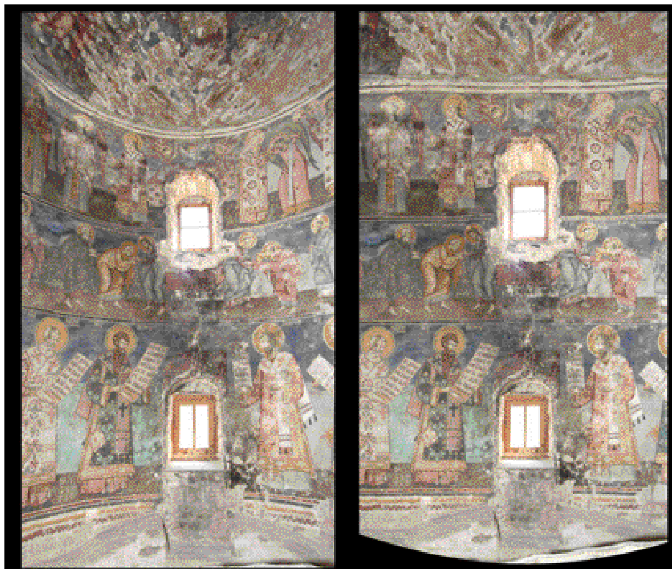
Figure 3 : Développement photogrammétrique du chevet, à gauche l'image originale, à droite l'image développée. ( R = 1.83 m, \sigma_R = 1.1 cm)
