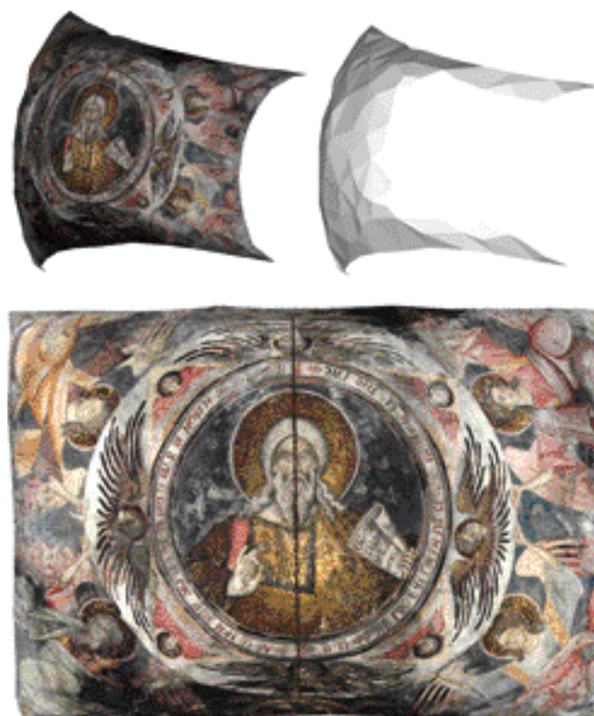
Figure 7 : En haut, modélisation d'une voûte quelconque, en bas, orthophotographie.
