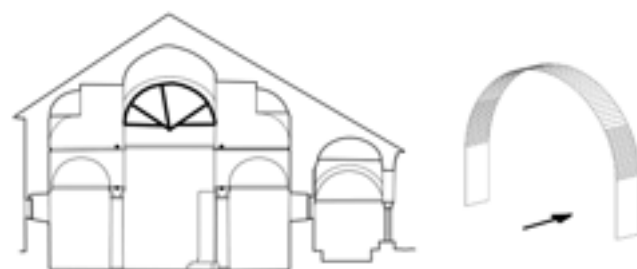
Figure 5 : Section transversale T4 (vue Est), et le doubleau principal composé de quatre portions circulaires.
