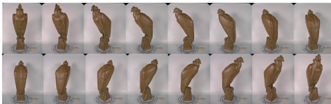
Schéma de prise de vue en anneaux [Eos systems, 03] et séquence d'acquisition pour le Condor de Bachelet.
