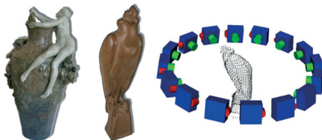
Exemple d'œuvres ayant subi une acquisition par projection de points : Les Raisins (Massoule), Le Condor (Bachelet), et nuage de points produit.
