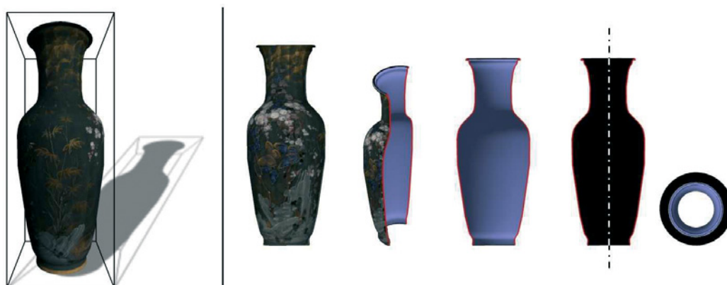
Caractérisation du volume de stockage et de la caisse de transport, dégagement des profils caractéristiques, sections et coupes.
