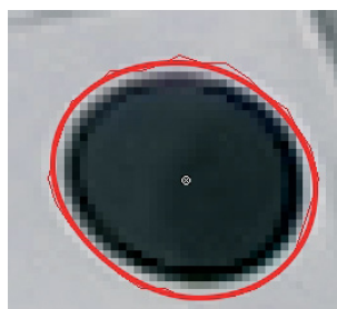
Point photomodeler centré sur la tache et ellipse pour le marquage sub pixel.
