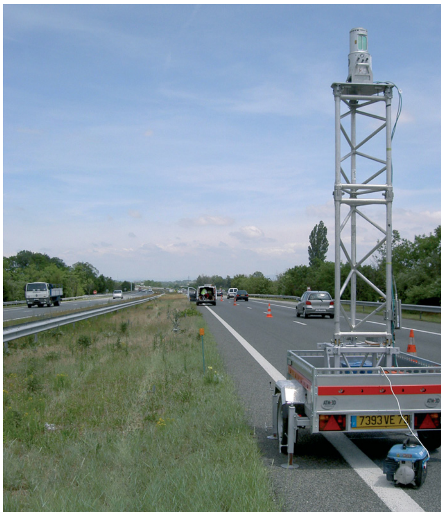
Figure 1 : Levé au scanner 3D sur 15 km des quatre voies de l'autoroute A42, sous circulation et en balisage léger (extension des voies en terre-plein central).
