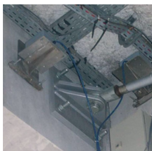
Figure 9 : Inclinomètres sur une poutre sablière.
