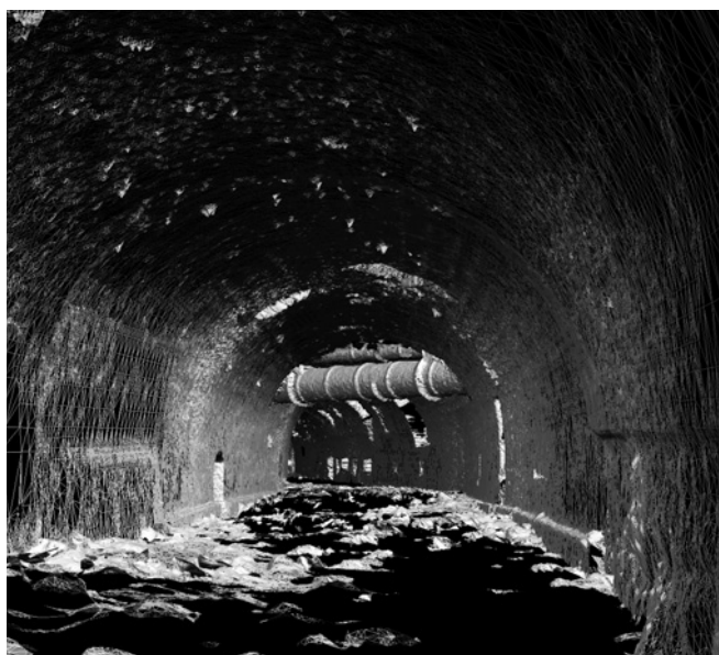
Figure 3 : Nuages de points et modèle 3D maillé en tunnel.
