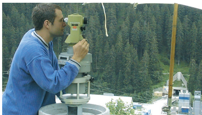
Le gyroscope sur le pilier du portail de Sedrun.
