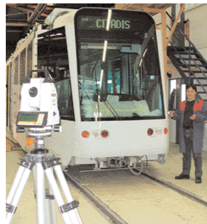
Figure 2 : mesure finale d'un CITADIS ALSTOM à l'aide d'un tachéomètre TDA 5005 LEICA, d'un prisme BAECHLER dia. 40 mm, d'une commande à distance infra-rouge et du logiciel Métride Dim Master
